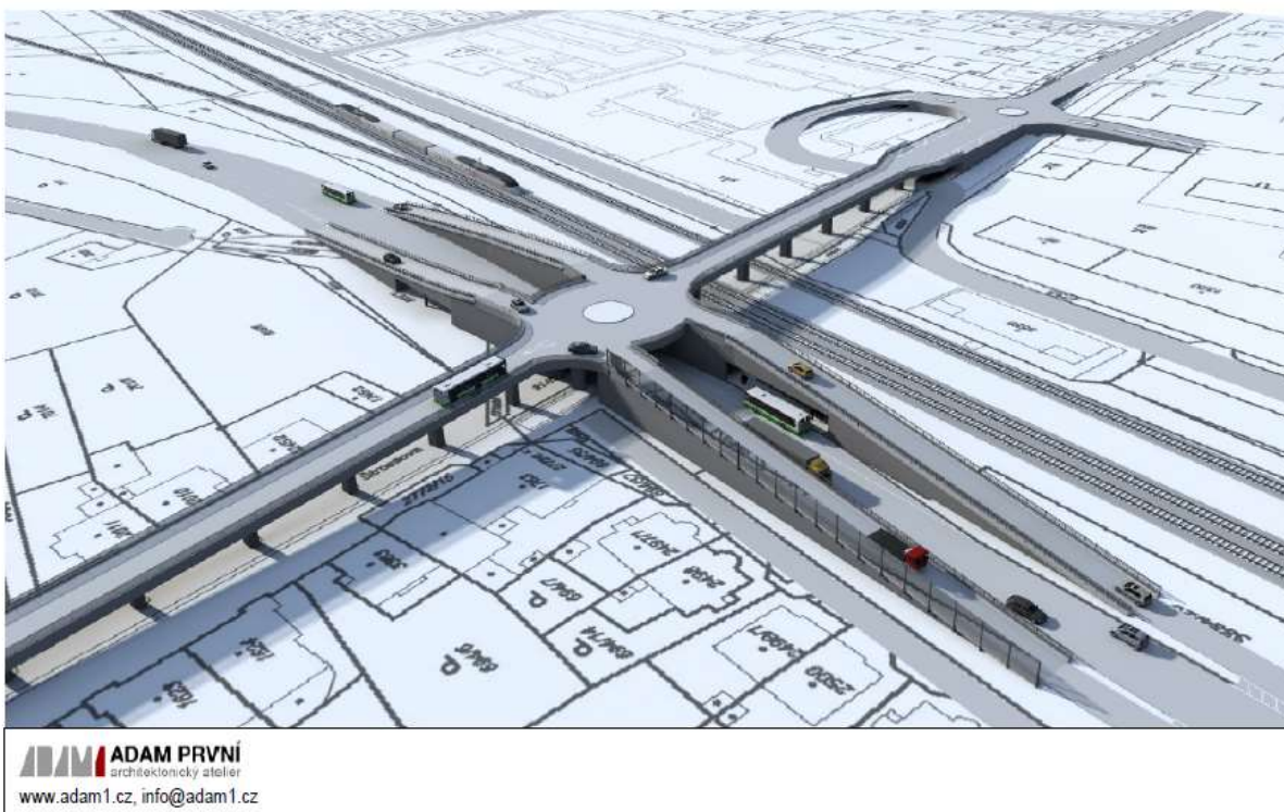
Obrázek 47: příklad možného dopravního řešení křižovatky Kpt. Jaroše-Kyjevská /zdroj: Studie dopravního řešení křižovatky I/36 s ulicí Kyjevská
