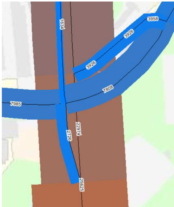
Obrázek 4.6: sjízdná rampa na silnici I/37 v MÚK Rosice, výhledové dopravní zatížení IAD [voz/24 hod.], rok 2035
